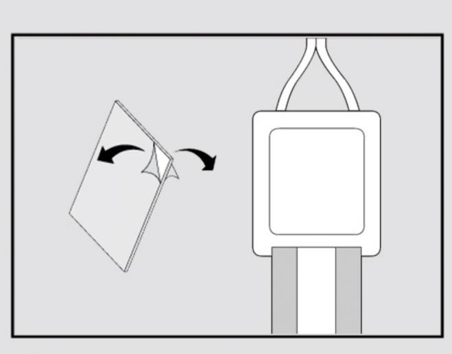
1. Fixer les connecteurs sur la surface ou le mur à l'aide de l'adhésif double face.
