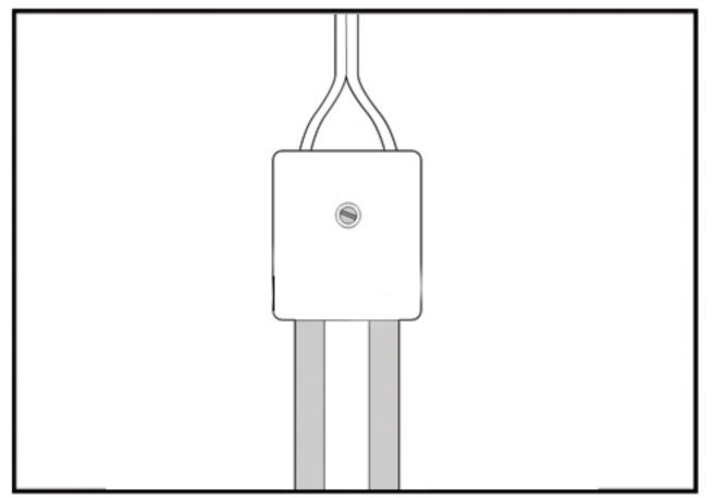
Fixer le connecteur B sur la surface ou le mur à l'aide du ruban adhésif double face.
